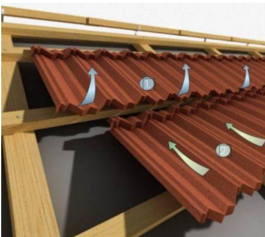
Podkládání šablony pod šablonu v předchozí řadě
